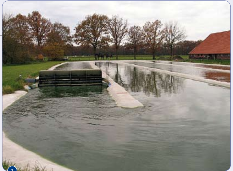
Fig. 1 Algenvijver (type raceway) voor de productie van Chlorella door Ingrepro BV (Borculo, Nederland). De algen worden door de vijver gepompt door middel van een schoepenrad om bezinking te voorkomen en algen periodiek aan het zonlicht bloot te stellen (bodem van de vijver is nagenoeg donker)
