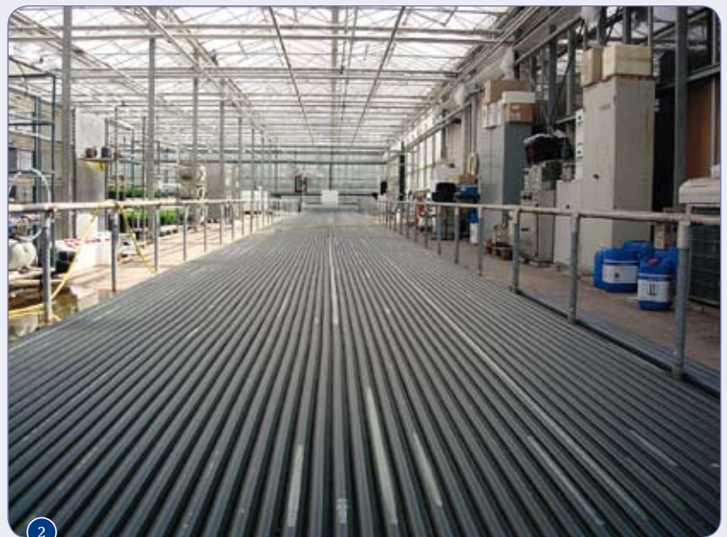
Fig. 2 Buizenreactor algenkweker LGem bij het glastuinbouwbedrijf Technogrow in Made (Nederland). LGem kweekt in deze systemen van transparante plastic buizen mariene algen die rijk zijn aan omega-3 vetzuren (zogenaamde visvetzuren). Dit kan op basis van zonlicht als wel als op basis van kunstlicht. De algencultuur wordt door de buizen rondgepompt van en naar een verzamelvat waar zuurstof wordt verwijderd en nutriënten, waaronder \text{CO}_2 , toegeediend
